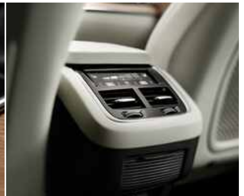
Четырехзонной системой климат-контроля можно управлять с центрального сенсорного дисплея или с изящной сенсорной панели управления в задней части консоли тоннеля.
