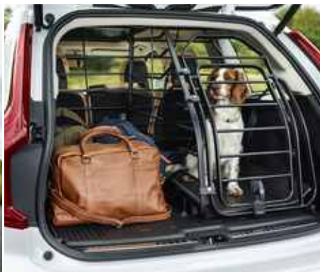
Защитная стальная решётка не позволит грузу попасть в салон при резком торможении. Продольный разделитель позволит создать де-факто два багажника, а специальная калитка удержит вашу собаку на месте.
