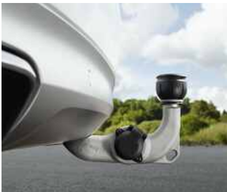
Полуавтоматический фаркоп выдвигается и убирается нажатием кнопки, когда в нём нет необходимости.
